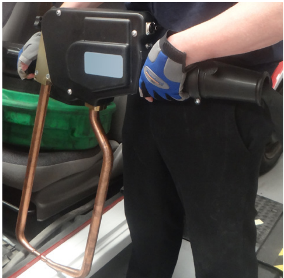
Figura 6.5. Pistola de soldar «tipo X» de un taller de reparación, con los electrodos de 550 mm instalados. Los dos electrodos se fuerzan uno contra otro en una acción de pinza gracias a la acción de un émbolo del cuerpo principal de la pistola (entre las manos del operario), que también incluye el transformador que alimenta la corriente de soldadura
