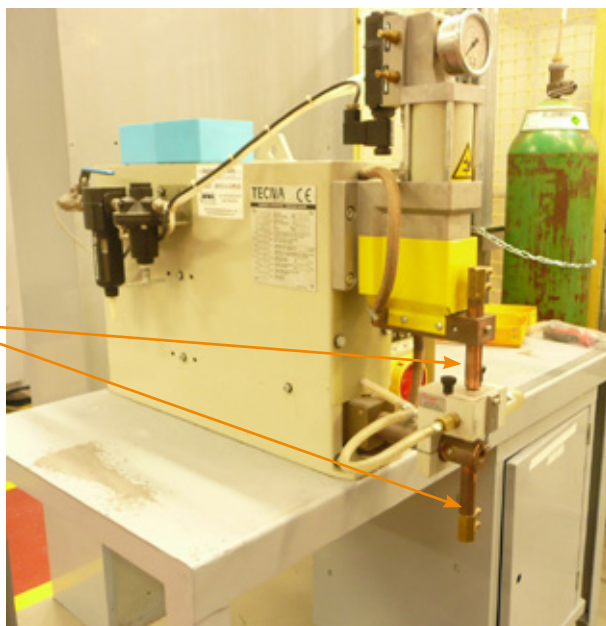
Figura 7.1. Equipo de soldadura por puntos de banco
