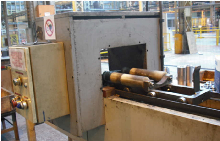
Figura 5.2. Desmagnetizador con carrito deslizante
